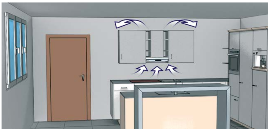
◀ Figure 1.2 Flux de l'air avec les hottes à recyclage d'air
