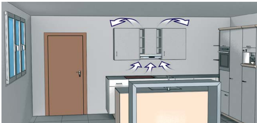
◀ Abbildung 1.2 Luftstömung bei Umlufthauben
